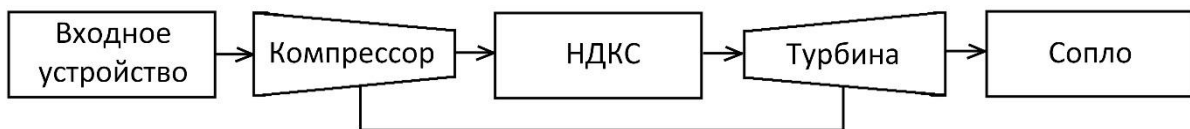
Рис. 1: Схема газотурбинного двигателя с НДКС.
